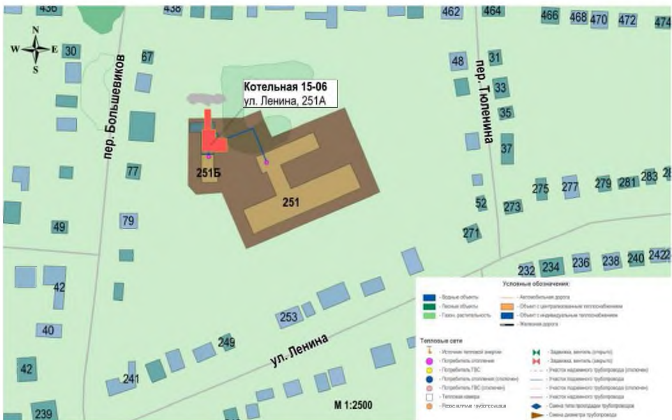
Рис. 3.18. Существующая зона действия систем теплоснабжения и источников тепловой энергии от котельной №15-06, ул. Ленина, 251а.
