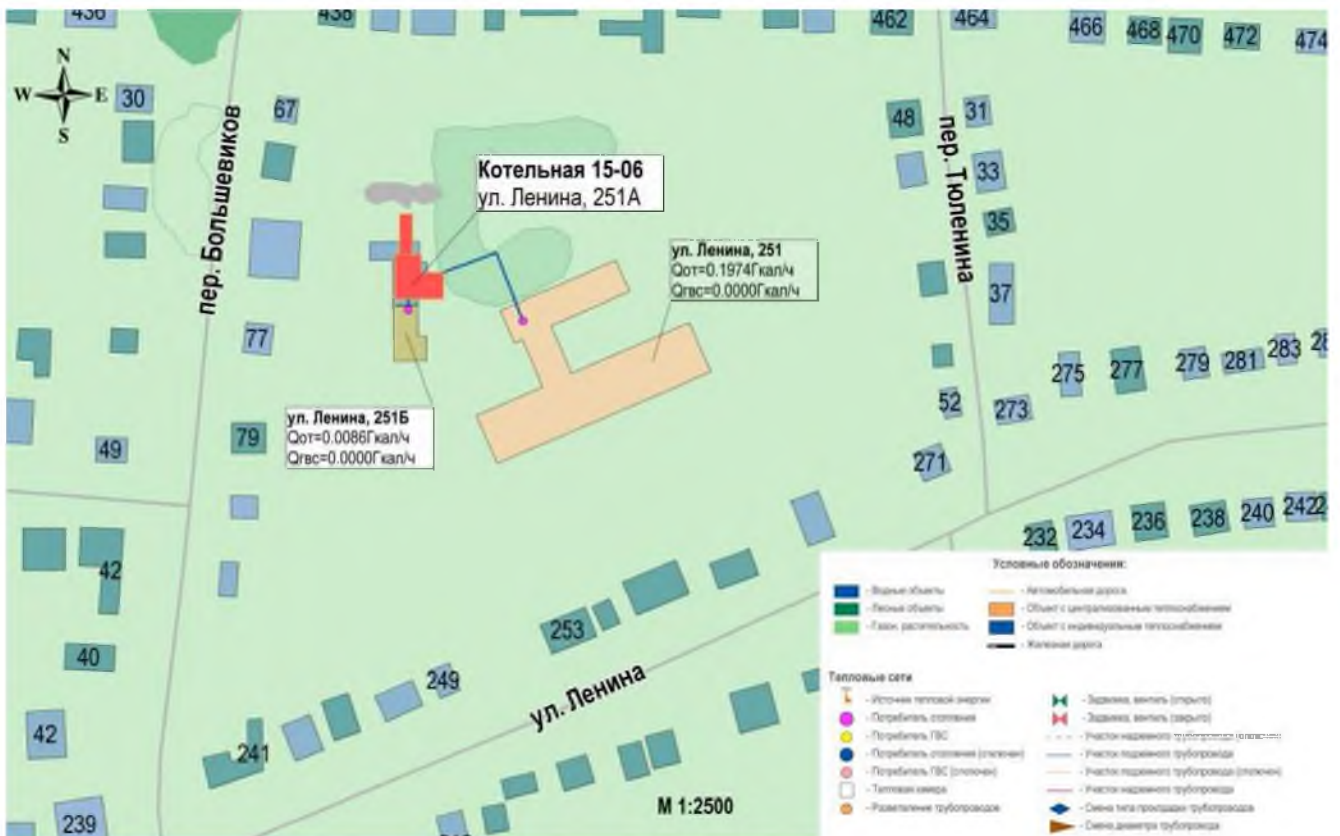
Рис. 2.5. Схема с указанием объемов потребления тепловой энергии от котельной №15-06, ул. Ленина, 251а.
